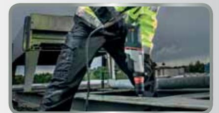
Multikalapács kétfokozatú hajtóművel Két fúrósebesség a fúrásban való gyors előrehaladáshoz az ütés nélküli fúrásnál, pl. gázbetonban, üreges téglában, fában vagy fémben
